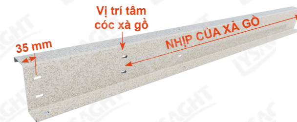
Hình 7.2.4.d Tại mỗi nối chồng: Lỗ cách đầu đoạn nối 35mm và ở tâm đoạn nối (ngay cóc xà gồ)
