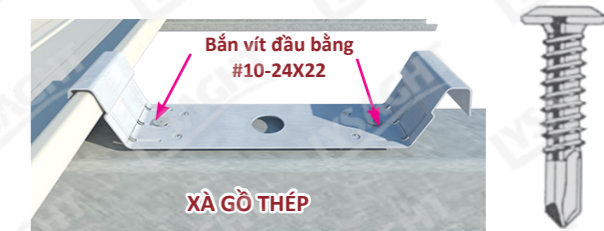
Hình 5.2.1.c Gắn đai KL65 với 2 vít đầu bằng #10-24x22
