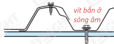
Hình 4.1.b Lợp tôn vách bằng vít xuyên qua sóng âm
